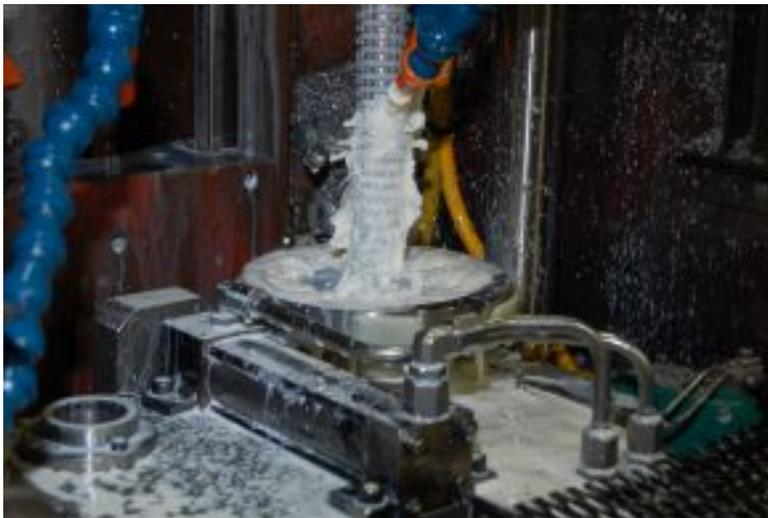
Внутреннее вытачивание шестерней (процесс в цикле потока *вытачивания*)
