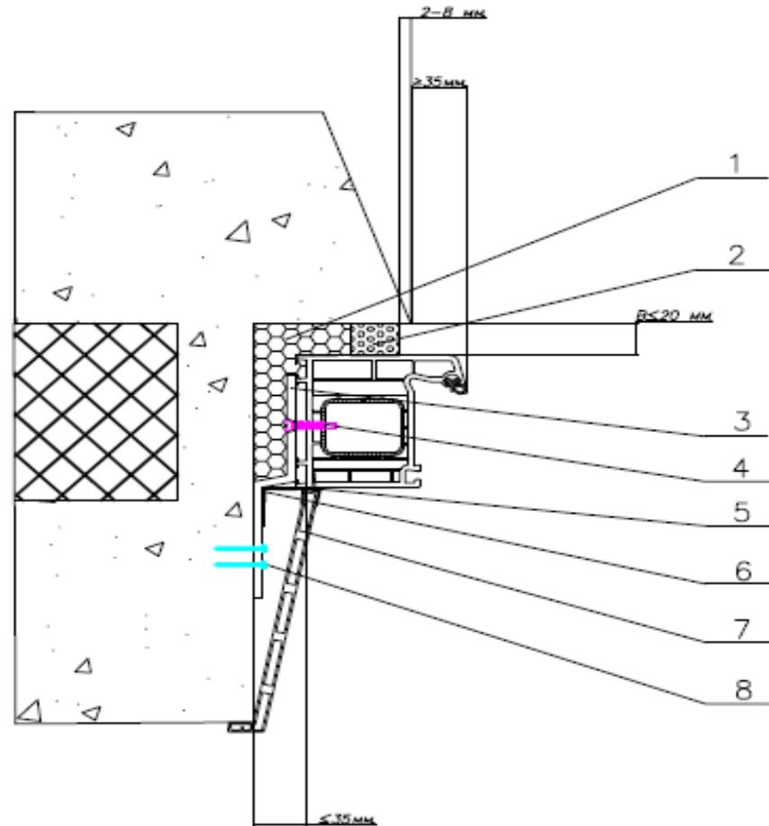
**Узел бокового примыкания оконного блока к проему
