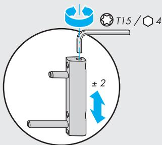
Регулировка по высоте и прижиму
